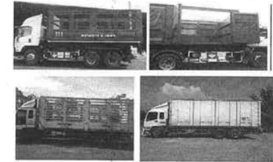
ภาพรถบรรทุกที่มีกระบะข้าง แบบบานพับ ใช้ขนส่ง Waste ประเภท กากของเสียที่บรรจุอยู่ใน IBCs, Drum สำหรับรถบรรทุกประเภทตู้คอนเทนเนอร์ ใช้ขนส่งแบตเตอรี่ใช้แล้ว, อุปกรณ์ไฟฟ้าใช้แล้ว, กากของเสียไม่อันตราย เป็นต้น
